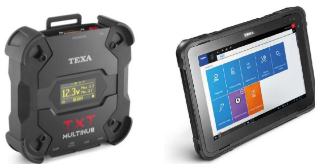
Fig. 1: A sinistra: componente hardware di misura NAVIGATOR, a destra: componente hardware HMI AXONE con installato il software IDC5
